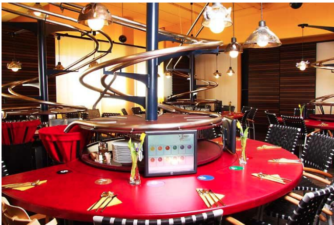
Рисунок 6. Первый в мире высокотехнологичный ресторан без официантов «S BAGGERS», Нюрнберг (Германия) На каждом столе вместо обычного меню есть сенсорное меню — установлен терминал с сенсорным дисплеем. Блюда, спускаясь по этим рельсам, как будто по американским горкам попадают вниз на столы посетителям https://touchblog.ru/s-baggers/
